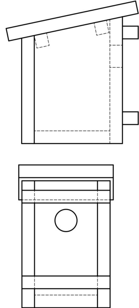
Infos: Alle Angaben in Millimeter. Dicke aller Teile: 20 mm; Eingangsloch evtl. schräg, damit Wasser nach außen abfließt; Dach mit rostfreiem Draht an Schrauben in den Seitenwänden befestigen; zur besseren Durchlüftung Ecken der Bodenplatte abschneiden oder einige kleine Löcher bohren.
